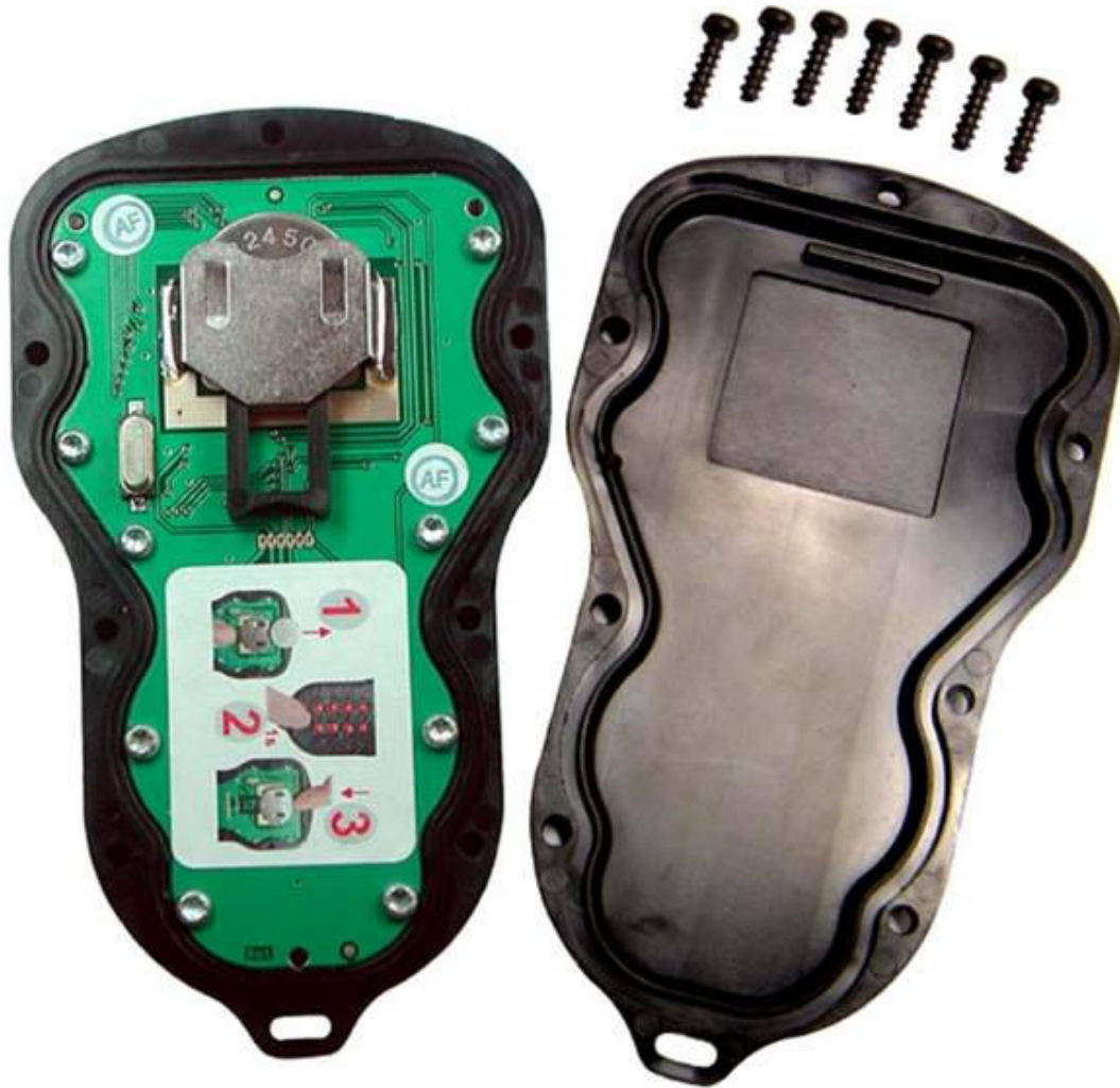
Opération à effectuer lors du remplacement de la pile: type CR2450
