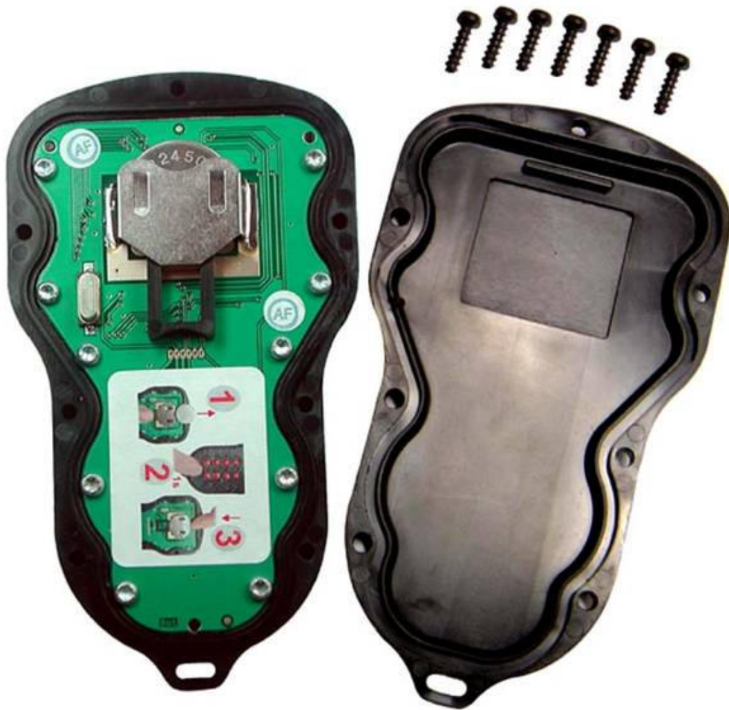
Operação a efectuar aquando da substituição da pilha: tipo CR2450
