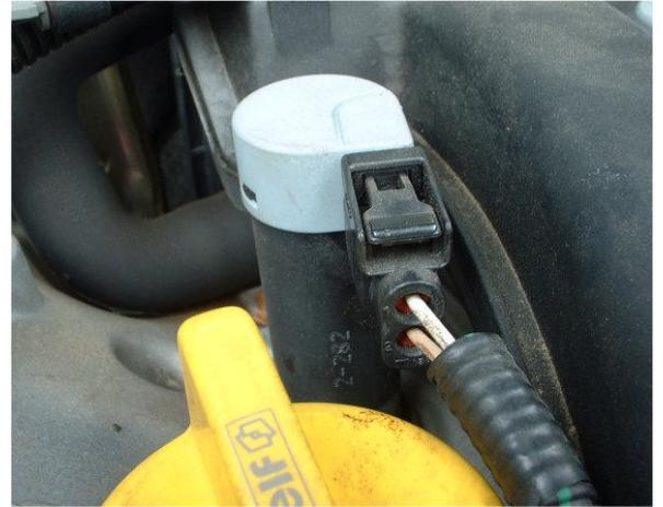
El proceso para localizar el hilo que indica la señal RPM es idéntico que para la bobina de alta tensión (estática) descrito más arriba.
